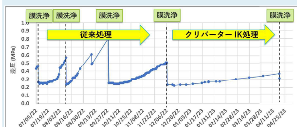
RO膜のスライム汚れ抑制による 差圧上昇抑制 ⇒ 高圧ポンプ消費電力削減の事例 (RO膜の洗浄頻度も大幅に低減)
