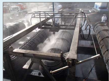
シェル側用自動ジェット洗淨装置の例
